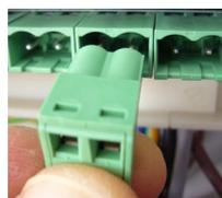
• Prestare attenzione all'inserimento dei connettori K497 nelle relative sedi in quanto hanno tutti un verso prestabilito; a tal proposito si presti particolare attenzione ai due casi relativi al cablaggio del display KD410/sonda K465 e dei moduli KPM40/KPM45.
